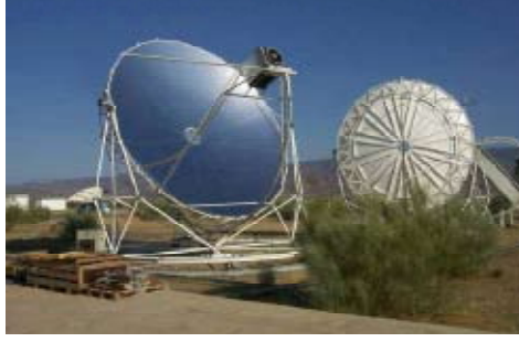
Şekil 2.23. İspanya Almeria'da kurulan çanak kolektör sistemi
