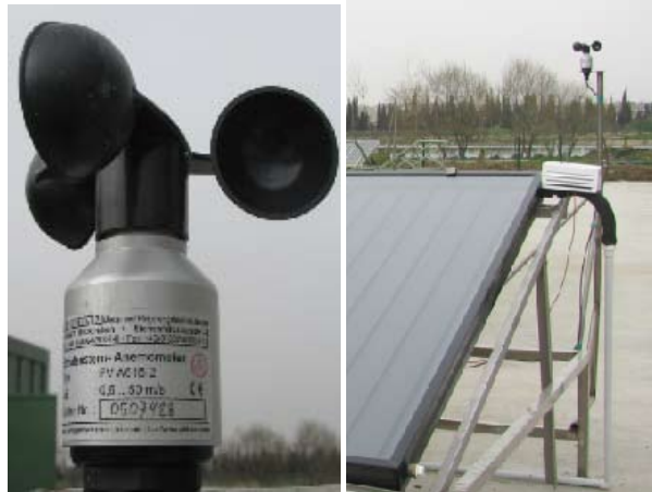
Şekil 5.18. Hava hızını ölçmek için anemometre ve kolektör üzerindeki konumu
